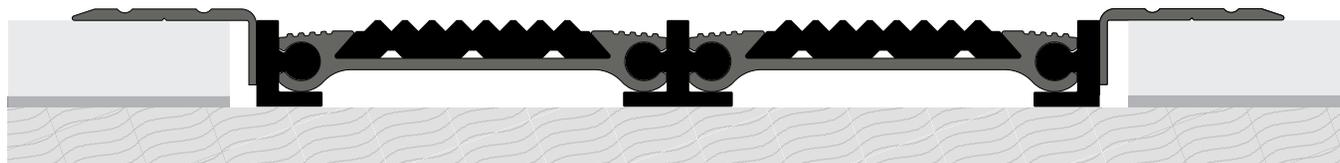
L'exemple du système en forme du tapis, changeant vers un plancher revêtu de carrelage
