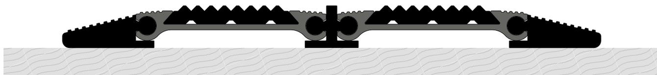
L'exemple du système encastré dans le revêtement du plancher en carrelage céramique
